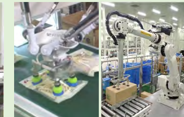
製品を箱詰めするロボット
