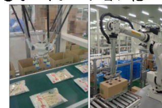
製品を箱詰めするロボット
