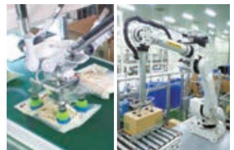
製品を箱詰めするロボット
